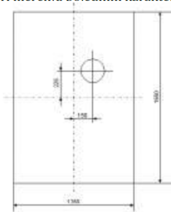
Slika 7.22 – Standardizovana ploča za merenje karakteristika zvučnika sa nesimetričnim mestom za ugrađnju mernog uzorka
